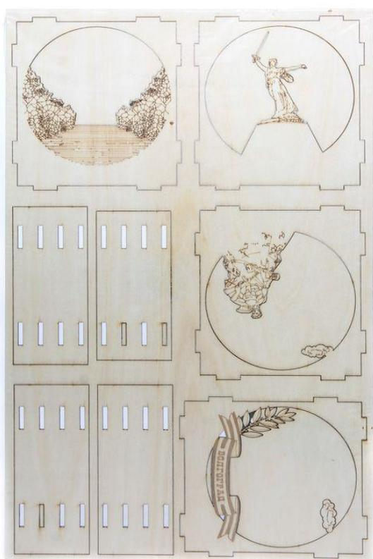
В интернете мы нашли схему для выпиливания из фанеры туннеля «Волгоград». В мастерской «Хайтек» с помощью определенных компьютерных программ нам помогли доработать эскиз будущего туннеля и выпилить его с помощью лазерной резки.
